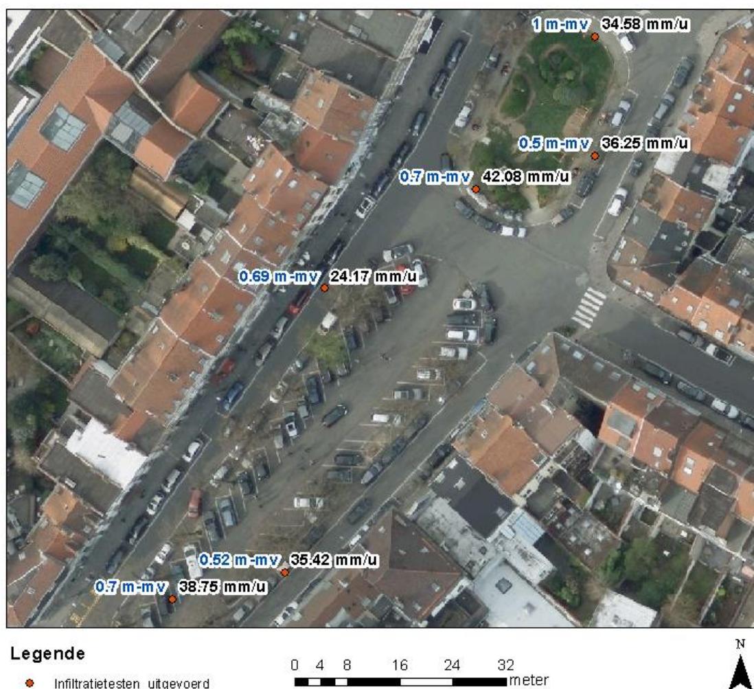
Figuur 2: Locaties van de infiltratiemetingen. Bij elke locatie wordt de diepte van de infiltratiemeting (blauw) en de infiltratiecapaciteit (zwart) weergegeven.
